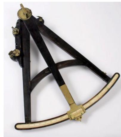
Ottante, anche detto quadrante riflettente - strumenti costruiti sul principio della doppia riflessione. Sfruttando tale principio l'ottante permetteva osservazioni precise, aveva l'ampiezza di un ottavo della circonferenza (da cui il suo nome) e, grazie al principio
